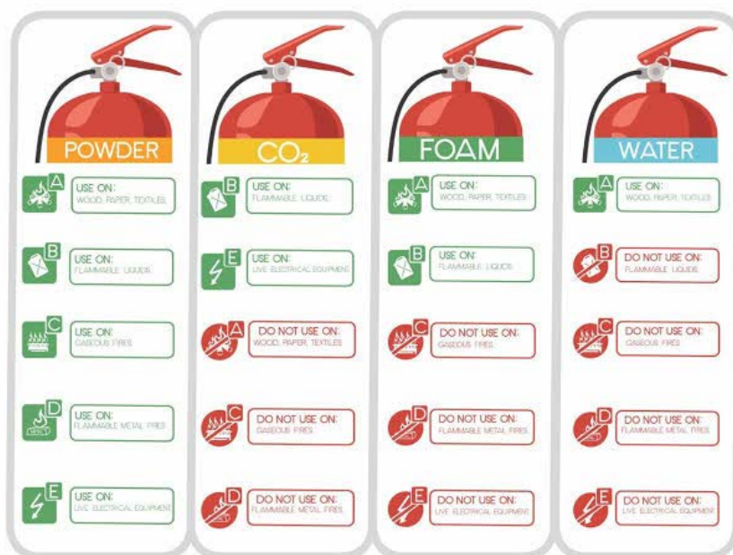
ภาพประกอบที่ 3.2-1: ถังดับเพลิงมือถือชนิดต่าง ๆ พร้อมป้ายแสดงประเภทเพลิงที่เหมาะสมกับการใช้งาน ที่มา - https://share.google/pelqtXtXRu5tOmvaz
